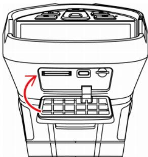
Drücken Sie die Abdeckung des Slots zu und schieben Sie diese in Pfeilrichtung, bis sie blockiert ist.
