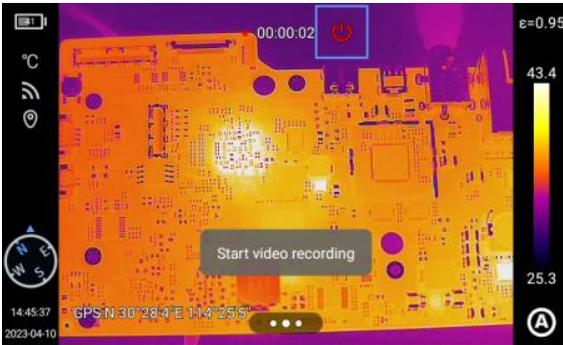
Gehen Sie zu Option **Einstellungen (Settings) ► Videoaufzeichnung (Video Recording)**. Berühren Sie **Videoaufzeichnung (Video Recording)**, um die Videoaufzeichnung zu starten, und drücken Sie die Taste **Zurück**, um zur Echtzeitansicht zurückzukehren. Drücken Sie die **[Auslösetaste]**, um das aktuelle Zielobjekt aufzunehmen, und drücken Sie dann erneut die **[Auslösetaste]**, um die Aufnahme zu beenden.
