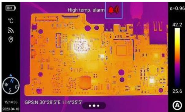
Wenn der Schalter für den Hochtemperaturalarm und der Schalter für den Niedrigtemperaturalarm gleichzeitig eingeschaltet werden, um sicherzustellen, dass das System die Einstellung für den Hochtemperaturalarm erkennen kann, sollte der Niedrigtemperaturalarmwert nicht höher sein als die Einstellung für den Hochtemperaturalarm.
