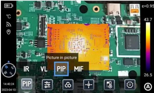
**PIP** – Bild-im-Bild – ein sichtbares Bild und ein Wärmebild werden angezeigt.
