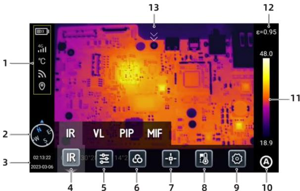
1. **Statusleiste.** Akkukapazität, WiFi, 4G-Netzwerk (bei einigen Modellen vorhanden), Standort.
