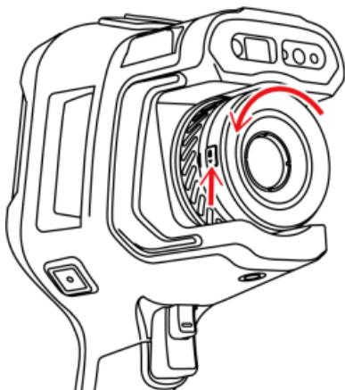
Drücken Sie die Objektivwechseltaste, drehen Sie das Objektiv gegen den Uhrzeigersinn und nehmen Sie es ab.
