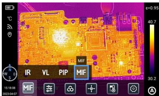
MIF – Wärmebild, das dem sichtbaren Bild überlagert ist.
