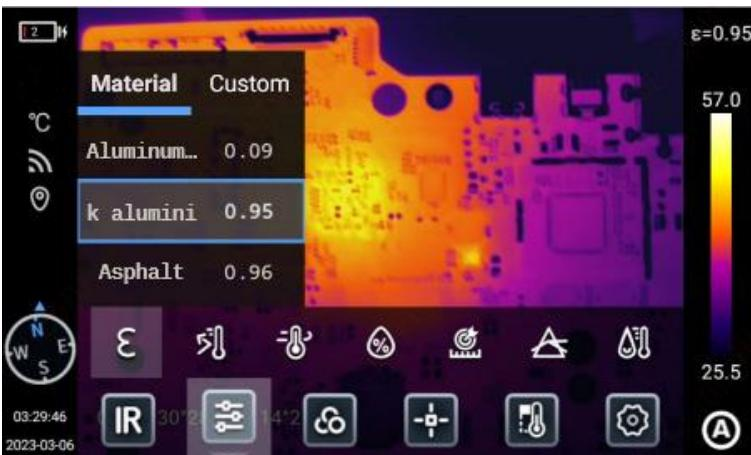
**Reflektierte Temperatur:** Wenn sich im beobachteten Bereich/Objekt ein Hochtemperaturziel befindet und der Emissionsgrad des beobachteten Ziels niedrig ist und das Ziel ein Hochtemperaturobjekt reflektiert, stellen Sie die reflektierte Temperatur ein. Die reflektierte Temperatur sollte auf die Temperatur des Hochtemperaturobjekts eingestellt werden. Der Benutzer kann die Parameter (-40...~2000) entsprechend den tatsächlichen Bedingungen variieren.
