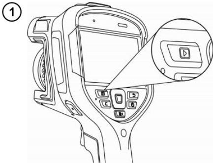
Drücken Sie die **Galerietaste** auf dem Gehäuse des Geräts.
