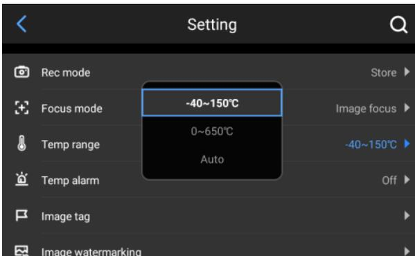
Gehen Sie zu **Einstellungen (Settings) ► Bereich der Temperaturmessung (Temperature Measurement Range)**, um das Suchfeld anzuzeigen. Der Benutzer kann den geeigneten Temperaturmessbereich für das Zielobjekt auswählen.
